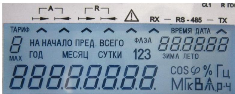
Рисунок 5 – Внешний вид ЖКИ с включенными элементами индикации
