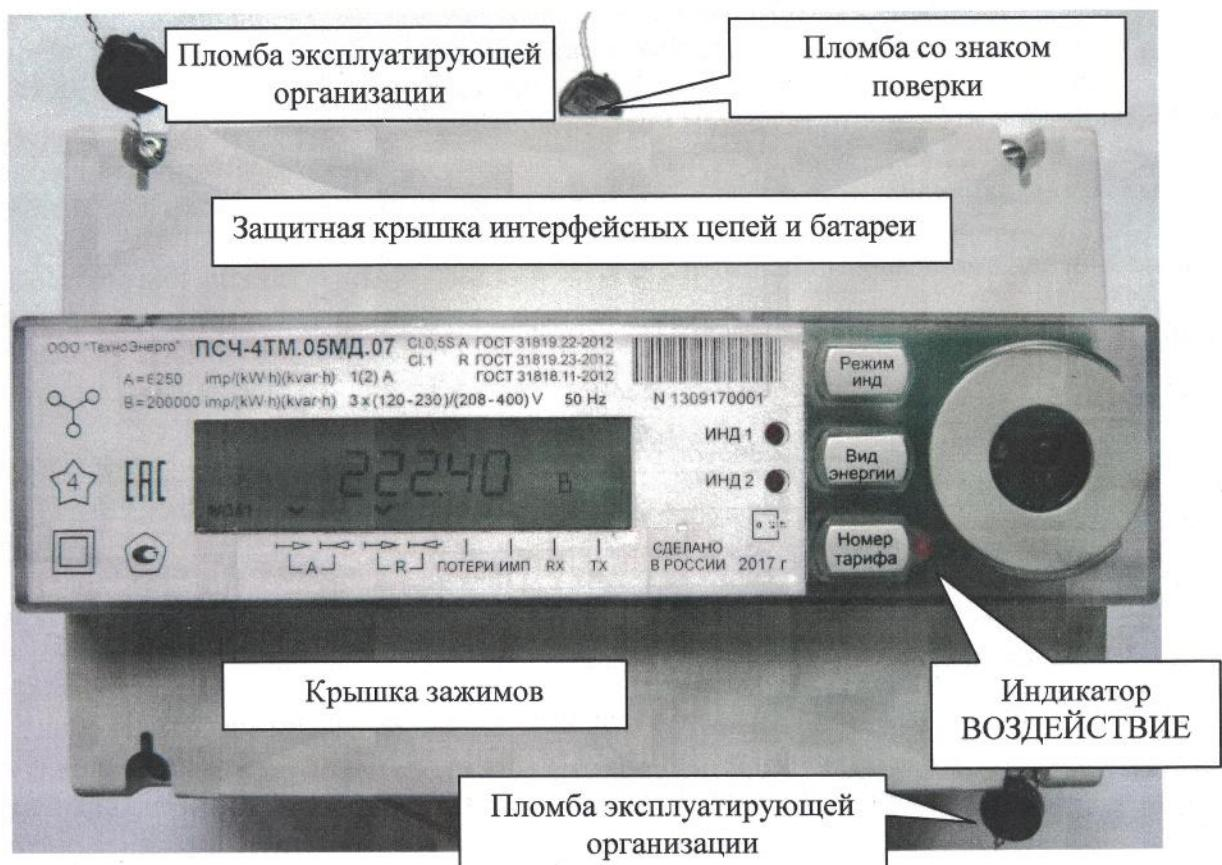
Рисунок 1 - Общий вид счетчика с закрытыми крышками, схема пломбировки несанкционированного доступа, обозначение места нанесения знака поверки
